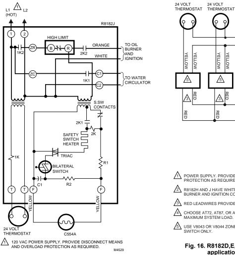
Fig. 15. R8182J internal schematic and wiring diagram.
